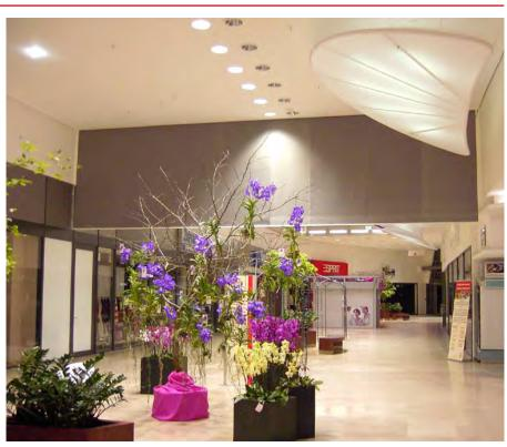
Dieses Beispiel zeigt sehr deutlich die Möglichkeit, das Smoke PROtec® System nahezu unsichtbar einzubauen. Der Vorhang ist in der abgehängten Decke integriert. Der Abrollkasten und die Abschlussleiste sind in der gleichen Farbe lackiert wie die Decke. Nur im Ernstfall wird die Rauchschürze sichtbar.
